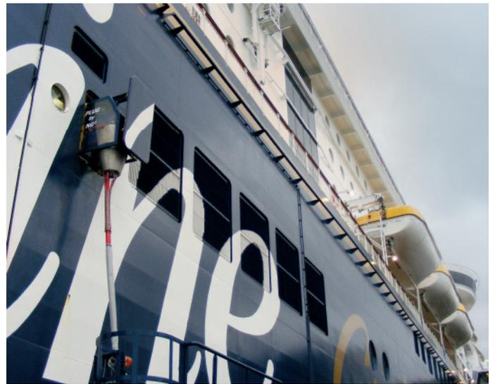
**Durch Landstrom können im Kieler Hafen künftig 60 Prozent des Energiebedarfs Kiel anlaufender Schiffe während der Hafentiegezeit mit Ökostrom versorgt werden.**
